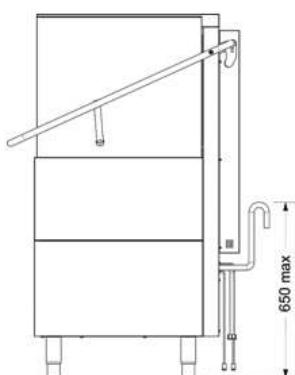
**Accorder une attention particulière à ce que le point le plus élevé du tuyau de vidange se trouve à une hauteur inférieure à 650 mm. Si ce n'est pas le cas, il se produira un retour d'eau.**
